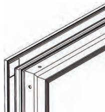
Fixação do esquadro base no aro
